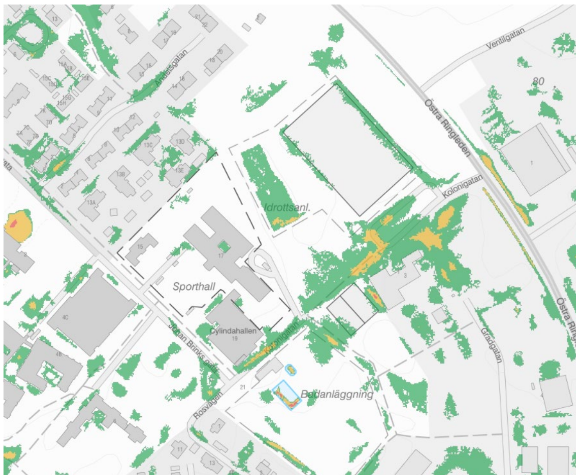
2Bilden ovan är ett skärmlägg från Scalgo som redovisar hur ett skyfall påverkar planområdet och angränsande bebyggelse idag. Flödena är beräknade utifrån ett 100 års regn motsvarande 50 millimeter. Grönt 0-20cm, gult 20-50cm, rött >50cm.
