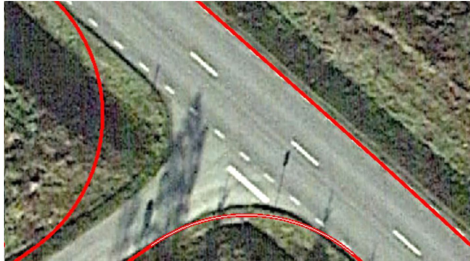
Bilden ovan är ett skärmläpp från trafikutredningen och redovisar hur stor korsningen vid Åsbultsvägen och Riksväg 47 kan bli utan kanalisering.
